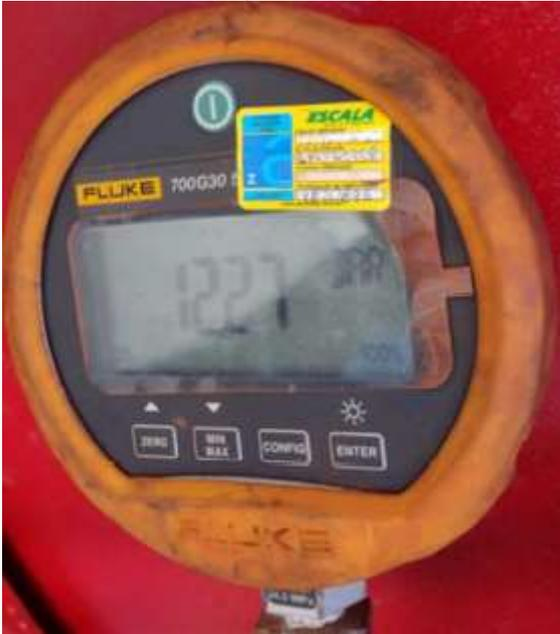
Durante todo o tempo de teste não houve nenhum indício de queda de pressão ou deformação na peça, portanto o equipamento está **APTO** a ser pressurizado nas condições de teste ou inferiores.
