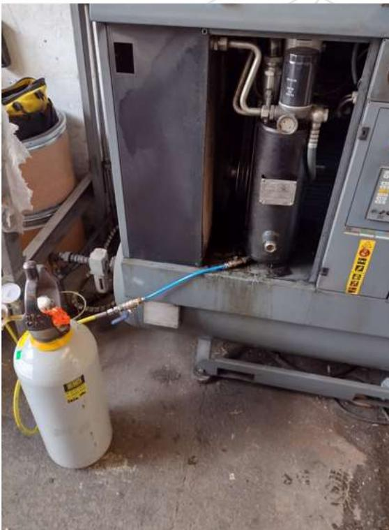
Com uma adaptação e a mangueira de alta pressão, o cilindro de N<sub>2</sub> é conectado ao vaso e sua pressão monitorada no ponto de injeção.
