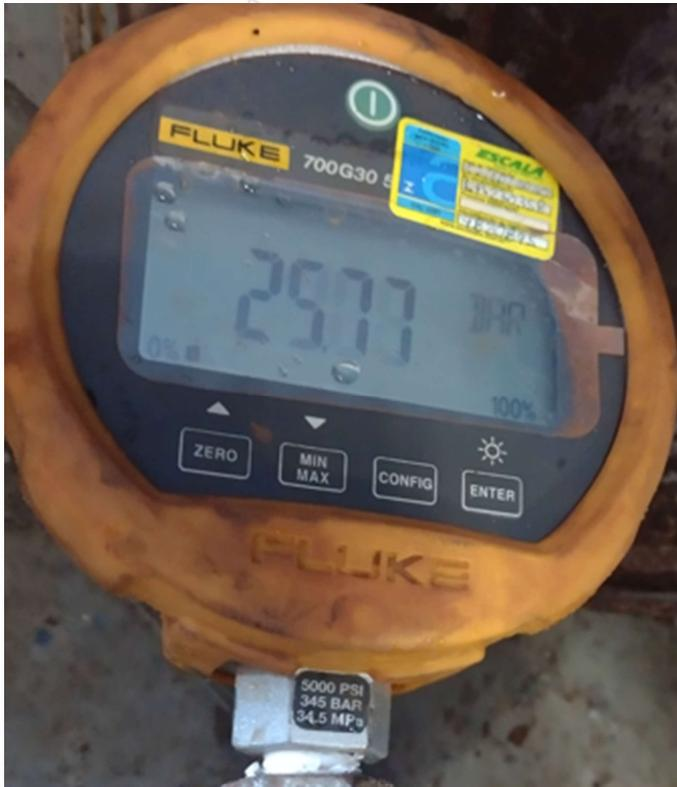
Durante todo o tempo de teste não houve nenhum indício de queda de pressão ou deformação na peça, portanto o equipamento está **APTO** a ser pressurizado nas condições de teste ou inferiores.
